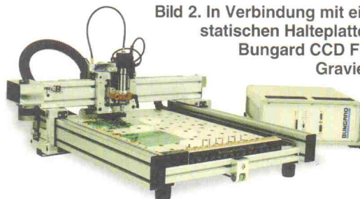
Bild 3. Alle VHF Fräs- und Graviersysteme verfügen über drei vollwertige Achsen.
